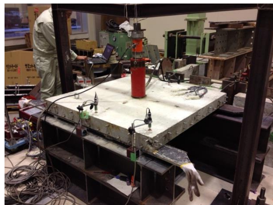
写真-2 基準床版 (劣化無し) 载荷状況 (金沢大学にて実施)
