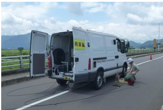
写真-1 载荷試験状況
