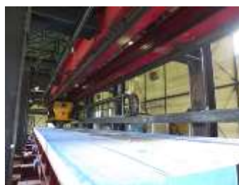
写真-1 輪荷重走行試験 (大阪工業大学)
