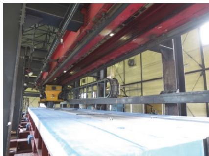
写真-1 輪荷重走行試験 (大阪工業大学)
