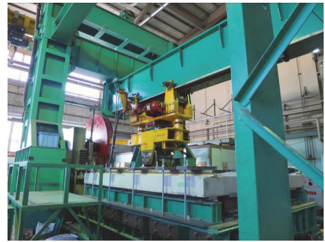
写真-2 クランク式輪荷重走行試験機 (寒地土木研究所)
