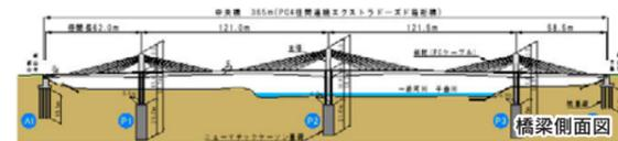
中央橋365m(PC4径間連続エクストラードロード箱桁橋)【長野県】
