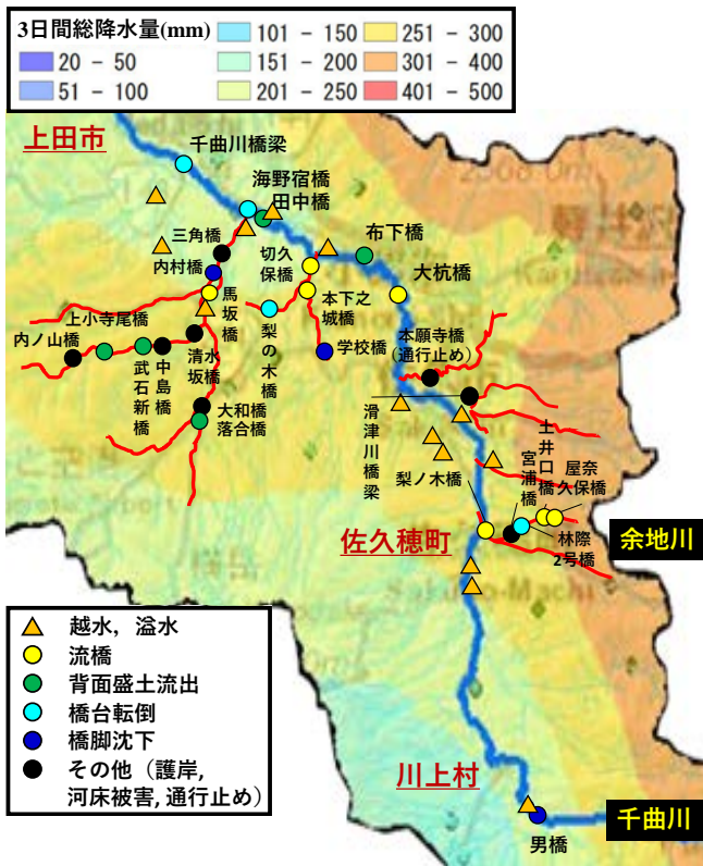
図-1 東信地区の3日間総降水量分布と主な橋梁被害箇所 6)
